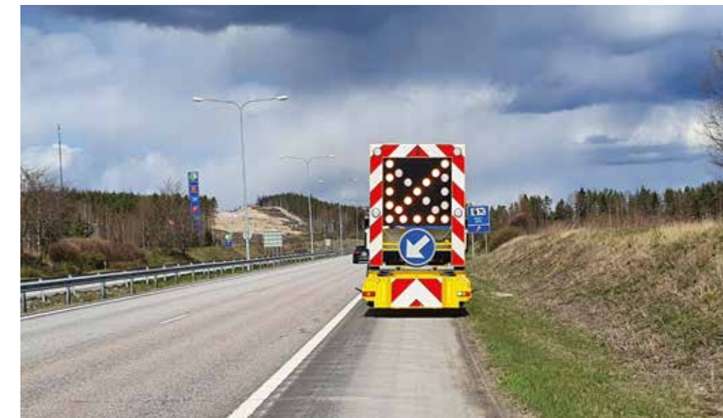
Suoja-auto varustettuna törmäysvaimentimella suojaamassa ajoratamerkin-tätyötä.
