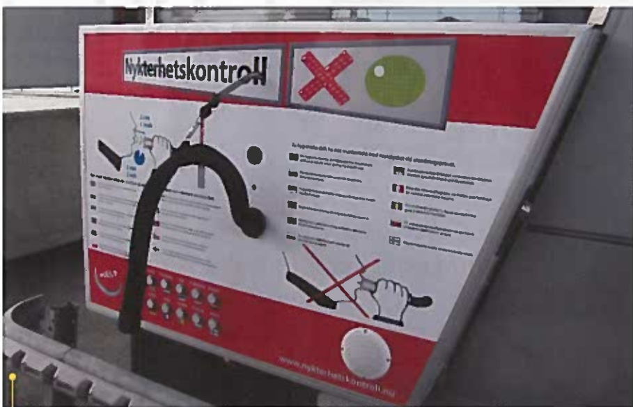
Puhalluslaite ja ohjeet kuljettajille 12 eri kielellä.
