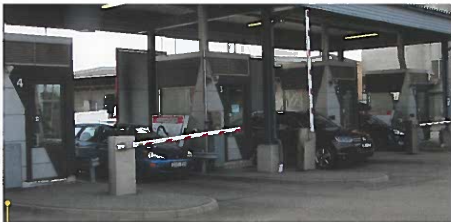
Puhalluksen jälkeen puomit avautuvat, mikäli puhalluskoe hyväksytään.
