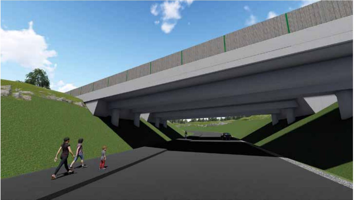
Sillan S10 visualisointi, tietomalli sekä mallinnettu raudoitus näkyminä Trimble Connectista.
