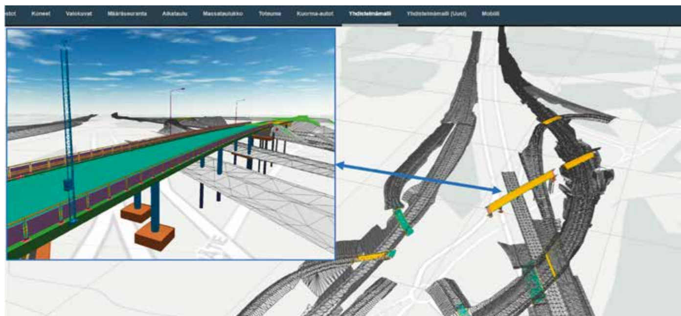
Siltojen IFC mallit ja projektin toteutusmalleja yhdistelmämalli näkymässä.
