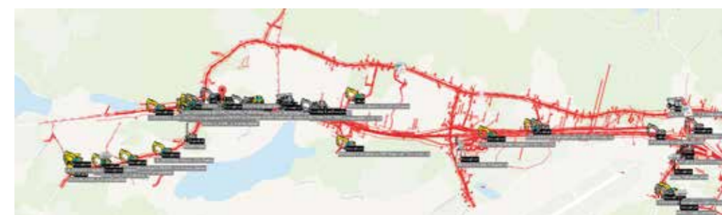
Eri koneohjausjärjestelmiä Infrakit hankkeella, koneille siirrettävien mallien lataaminen tapahtuu reaaliaikaisesti (V14 Kirri-Tikkakoski, Destia Oy).
