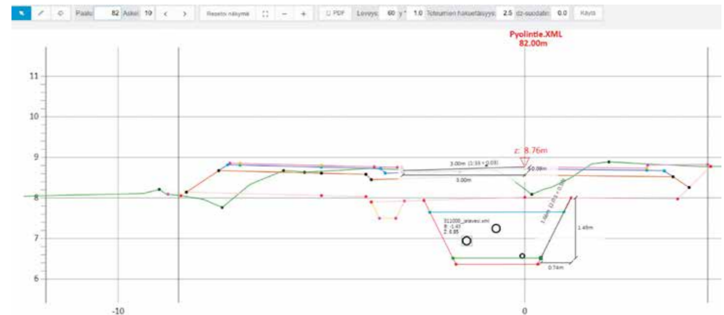
2D poikkileikkaus mittalinjan suhteen, toteutusmallien pinnat ja tarkastusmittauksia.
