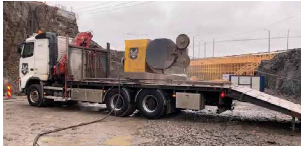
Kuva 6. Atlas Copcon Speedcut 100. Aina jos mahdollista, sahan kiskot asetellaan kuorma-auton tasaiselle laverille.
