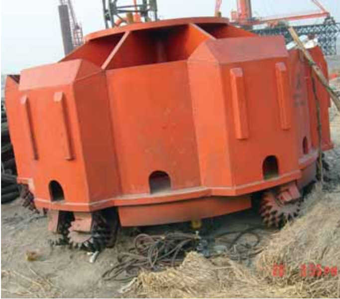
Kaivinpaalun porakoneen jyrshintäteriä.
